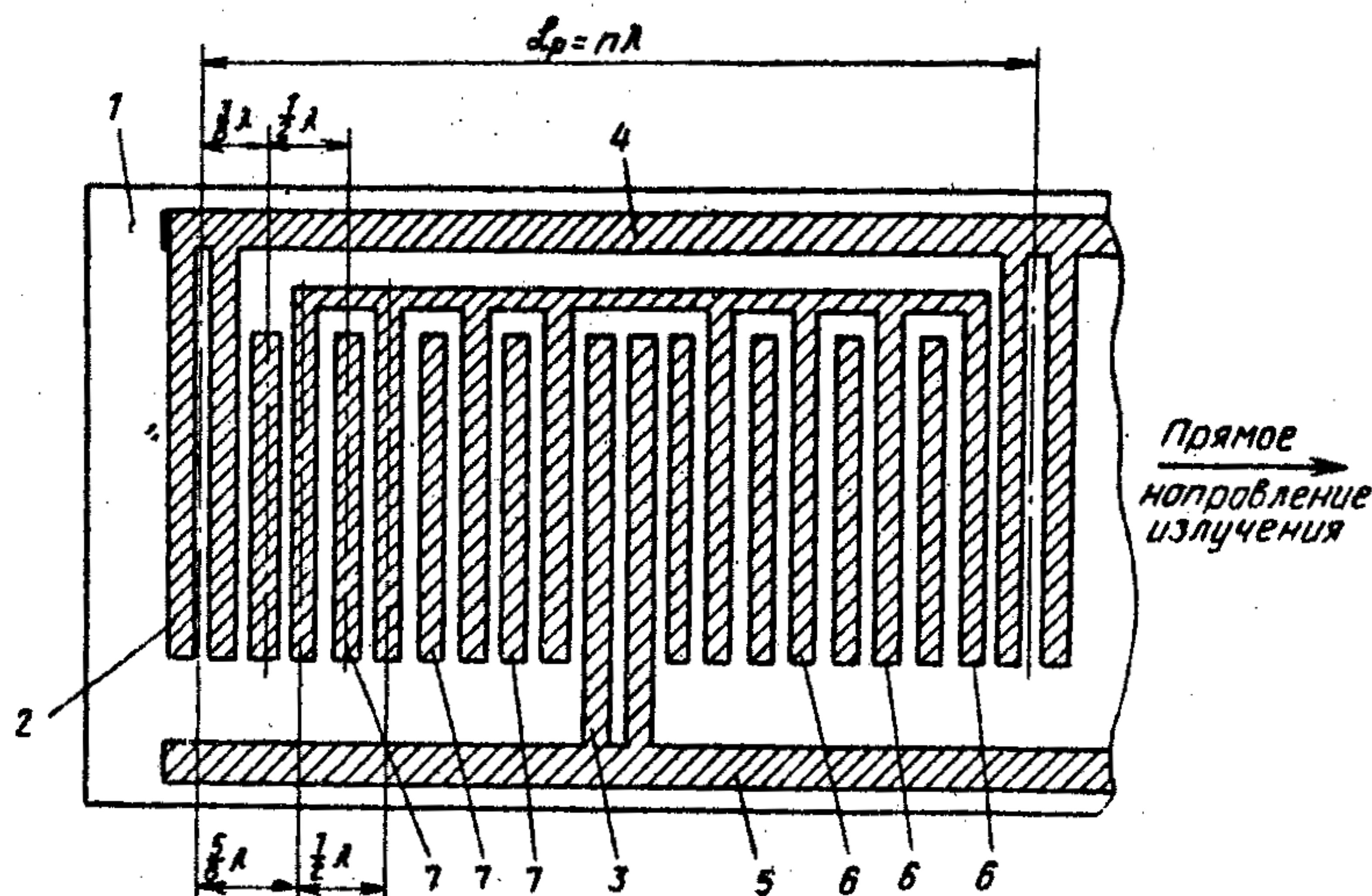
ного отражающих электродов выбраны из выражений  $l_{k_3} = 3/8\lambda + k_1\lambda/2$ ;  $l_{k_3} = 1/8\lambda + k_2\lambda/2$ , где  $k_1 = 0, 1, 2, \dots, (n-2)$ ;  $k_2 = 1, 2, 3, \dots, (n-1)$ . Использование изобретения позволяет на 15-20 дБ увеличить нап-
