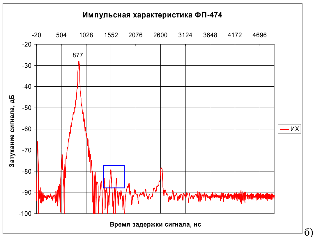
Рис.4 – Частотная (АЧХ и ГВЗ) (а) и импульсная (б) характеристики фильтра ФП-474 (70В38v1 D) после устранения влияния паразитных отражённых волн.
