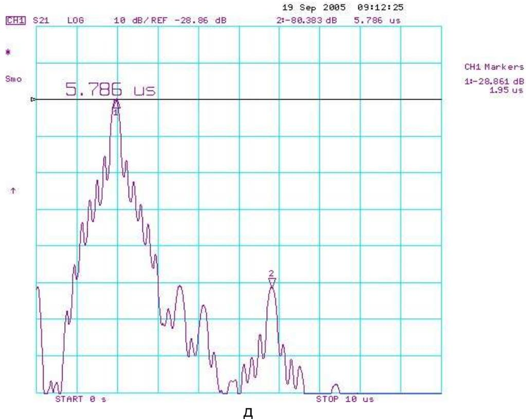
Измеренные частотные характеристики фильтра ФП-53 (140В4,8):
