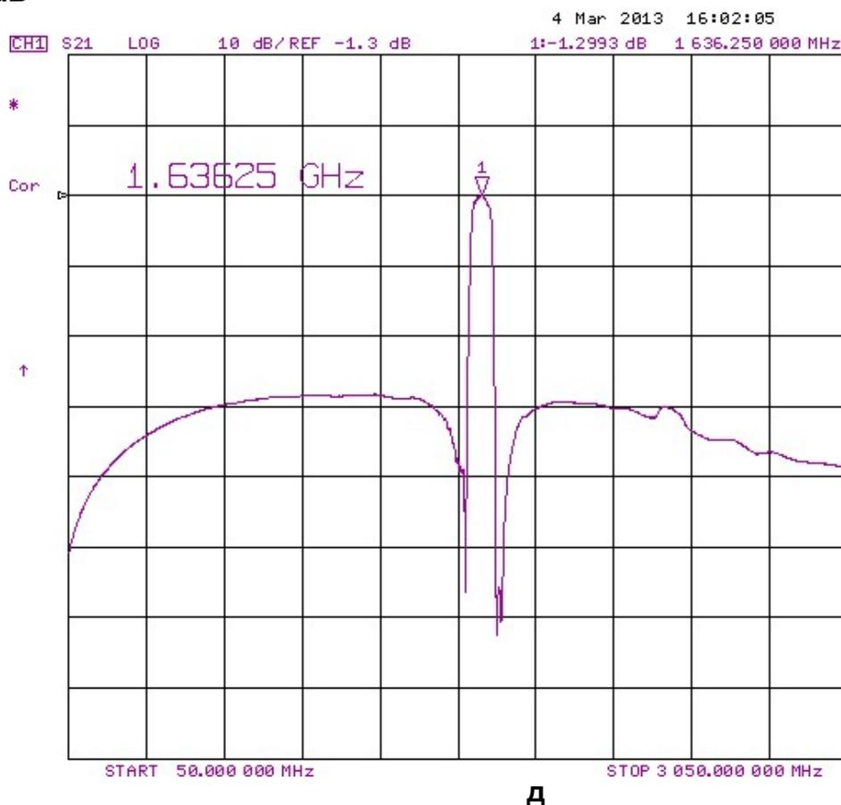
**Измеренные частотные характеристики фильтра ФП-6016 1642В35 МГц:**
