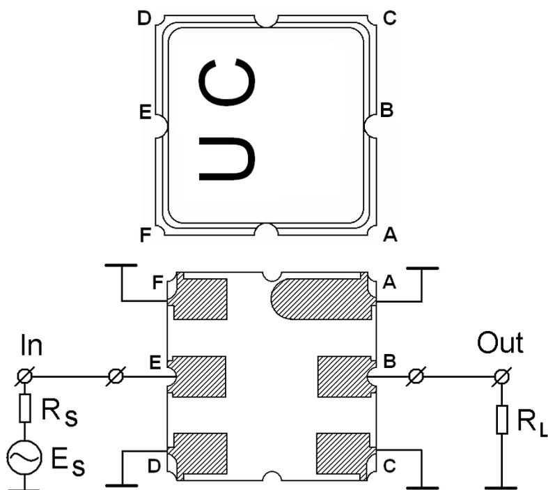
2.1 Сопротивление генератора:  $R_S = 50 \text{ Ом}$ .
