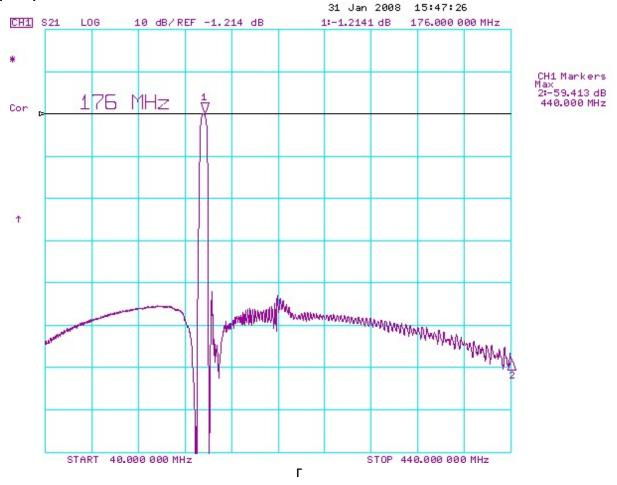
Измеренные частотные характеристики фильтра ФП-669 175,5В5 МГц:
